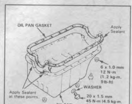
Fig. 135 Oil pan assembly—4WD Wagon
